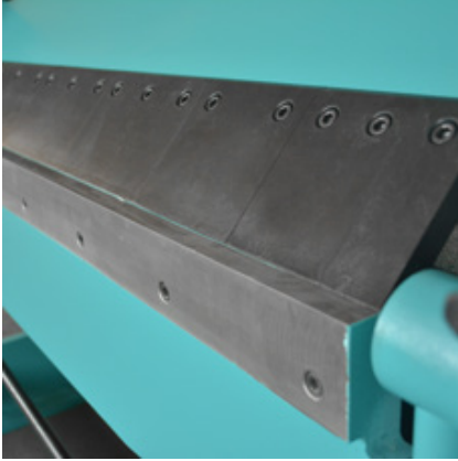
Parçalı Üst Bıçaklar Segmented Upper Blades
