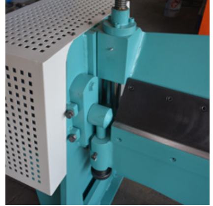
Motorlu Üst Çene Sıkma Motorized Upper Clamping
