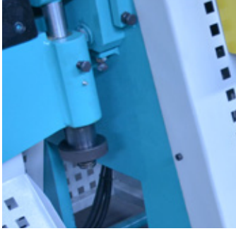
Kolayca Ayarlanan Alt Çene Açıklığı Easy Adjustable Lower Beam Space for Setback
