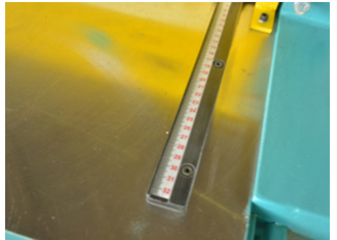
Düzgün kesim sağlayan Tabla Dayaması Table Side Support for Straight cuts
