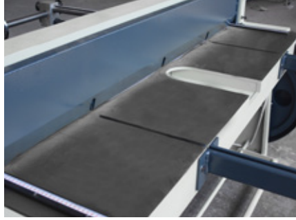
Döküm Taşlanmış tabla Cast Iron ground Table
