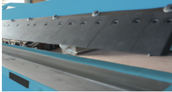
Standart Arkor Kaplamalı sert bıçaklar Standard Arcor Coated hard blades
