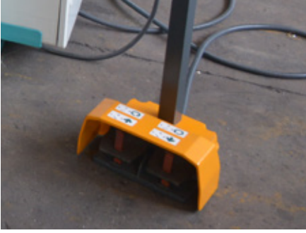
Serbest Çalışma Sağlayan Ayak Pedalları Handsfree Operation Enabling Footpedal
